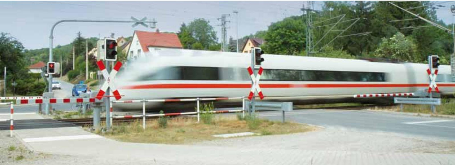
Bahnübergangssicherungssysteme von Siemens haben sich weltweit bewährt und zeichnen sich durch Sicherheit, Zuverlässigkeit und Wirtschaftlichkeit aus. Simis<sup>®</sup> LC ist ein hochverfügbares, modulares Bahnübergangssicherungssystem, das leicht an die Gegebenheiten des einzelnen Bahnübergangs sowie an die jeweiligen kundenspezifischen Anforderungen angepasst werden kann.
