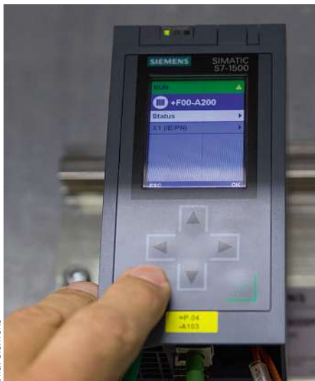
Bild 2: Eine Steuerung der Reihe Simatic S7-1500 steuert und regelt die gesamte Anlage. Ein Blick auf das integrierte Display zeigt dem Instandhalter wichtige Diagnoseinformationen.
