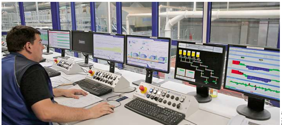
Bild 3: Die Anlage wird von der Warte aus bedient und beobachtet. Die Bedienoberflächen wurden mit WinCC unter dem TIA-Portal projektiert.
