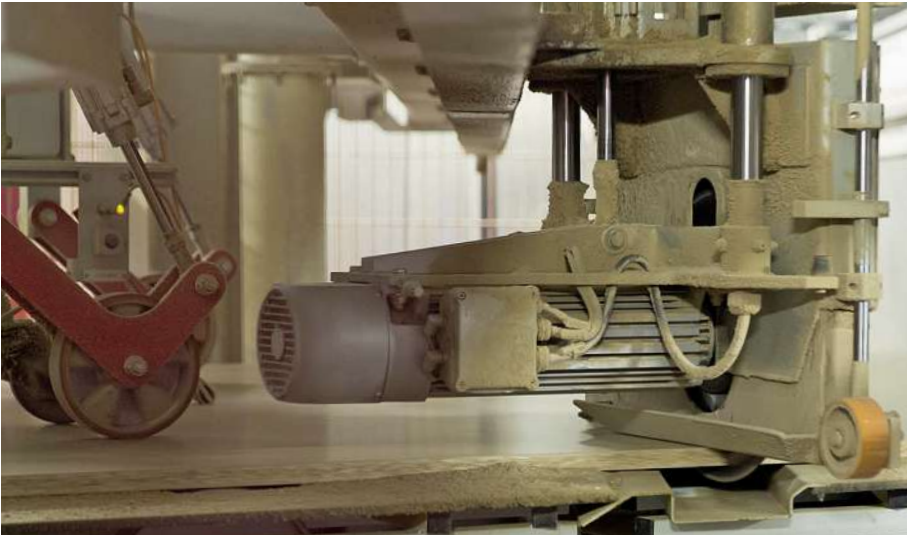
Bild 4: Hohe Geschwindigkeit und große Materialbreite der fliegenden Säge stellen eine besondere Herausforderung für die Steuerung dar.
