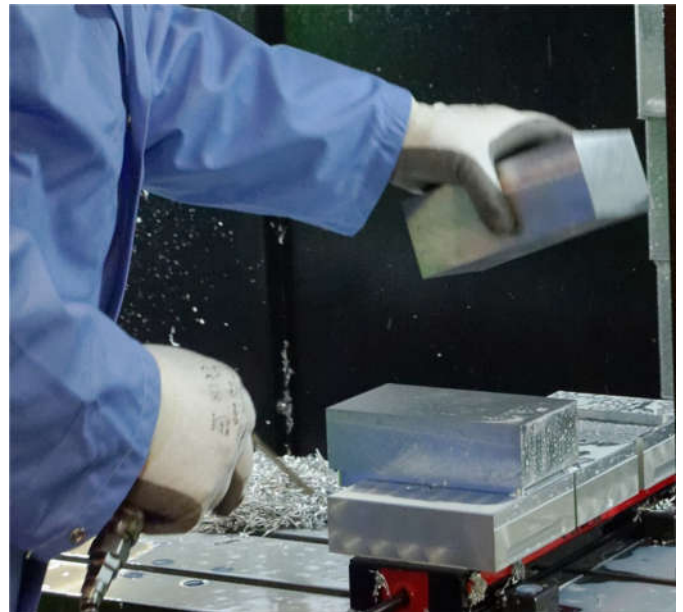
Aufspannung im Doppelschraubstock: Hinten der neue Rohling (Unterseitenbearbeitung), vorne das an der Unterseite vorbearbeitete Werkstück
