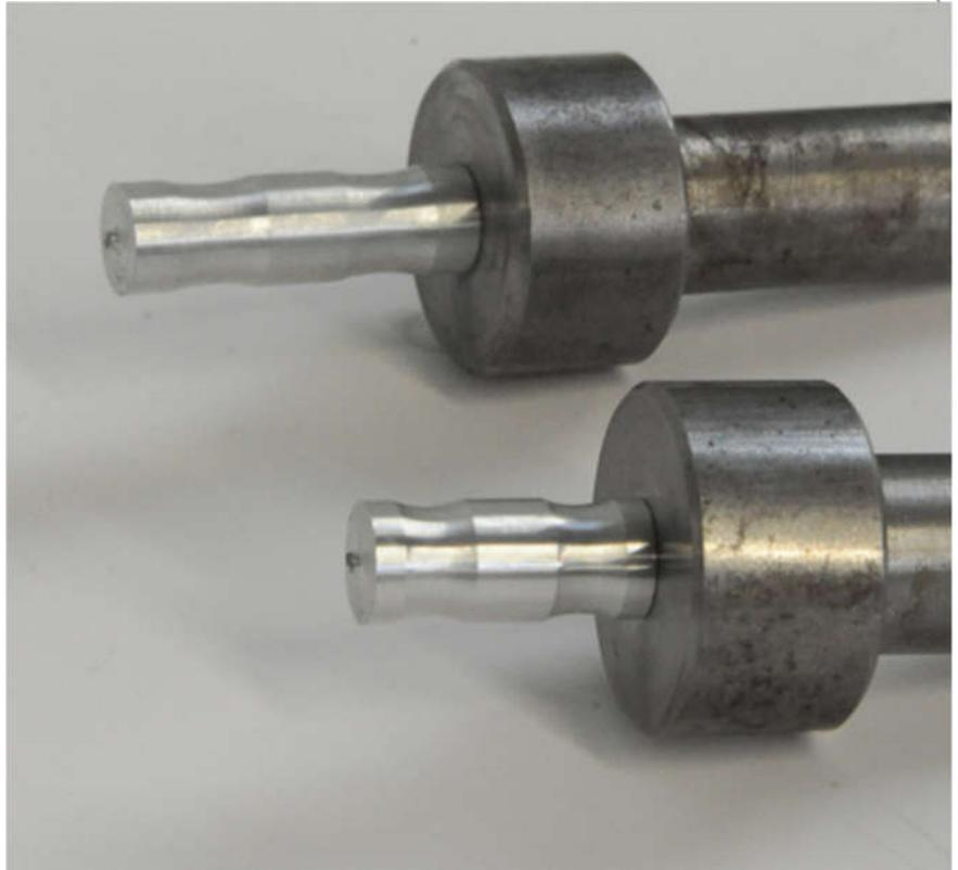
Zwischenstand mit den alternativen Werkstücken für Schaftsegment 3. Es wird nur eines von beiden benötigt.
