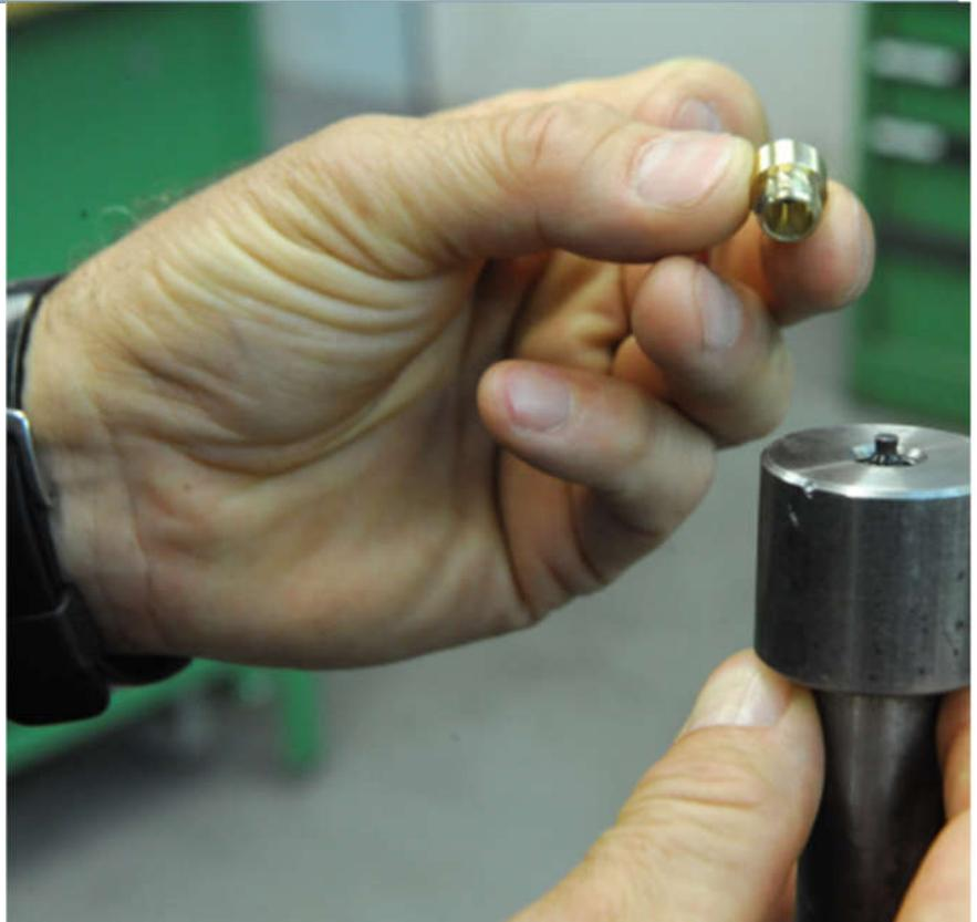
... und mit dessen Madenschraube verkontert, damit es sich während des Gravierzklus (mehrere Drehrichtungswechsel!) nicht aus der Verschraubung löst.
