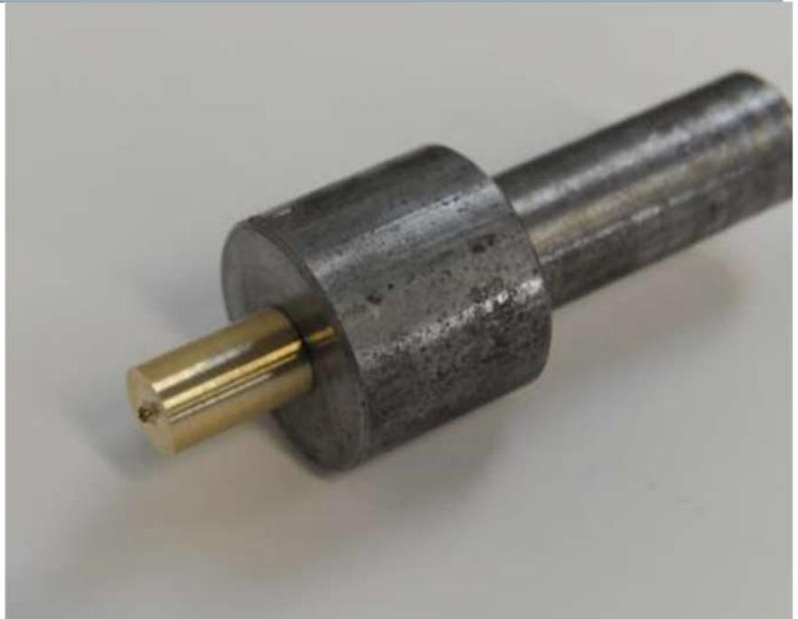
Vorrichtung auf Linksanschlag einspannen und Kugelschreiberspitze mit Teileprogramm KugelschrSpitze\_02 fertigbearbeiten. Vor dem Ausspannen Passung der Kappe auf festen Sitz kontrollieren. Wenn die Kappe nur mit erheblichem Kraftaufwand auf die Spitze zu bringen ist, dann im Konturabschnitt des Teileprogramms den Konus minimal verkleinern und diesen Schritt noch einmal ablaufen lassen. (Kappe vorher wieder entfernen)
