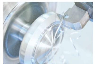
Erstseitenbearbeitung des Endstopfens wie bei den bisherigen Werkstücken, das Teileprogramm dazu ist KugelschrEndstopfen\_01. Nach der Erstseitenbearbeitung wird das Werkstück in Vorrichtung 4 eingeschraubt ...
