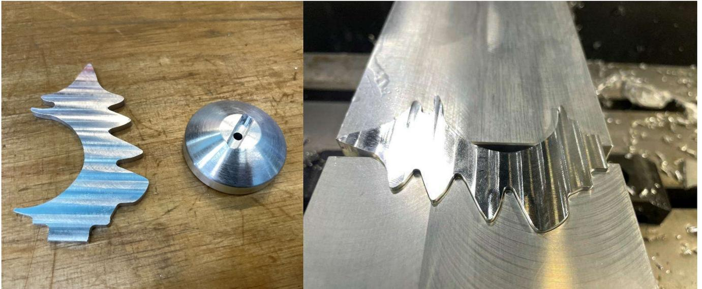
*Frästeil (= Kugelhalter mit Baumkontur)
