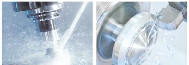
Der Pin wird in einer Aufspannung gedreht. Zuerst werden die Kontur und das Gewinde gedreht. Das Teil wird abgestochen und damit ist die Drehbearbeitung beendet.
