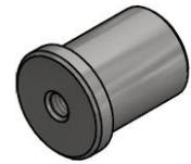
Für die nachfolgende Bearbeitung ist zu beachten, dass die Lage der Drehmeißelschneiden und die Drehrichtungen so gewählt werden, dass sich das Bauteil während der Bearbeitung nicht herausschraubt.
