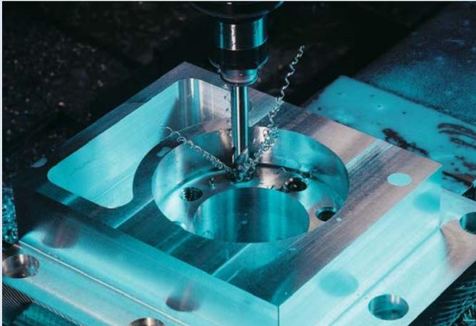
Bei der 3-Achs-Bearbeitung erfolgt die Bearbeitung durch Programmierung der drei Linearachsen. Die Kontur wird synchronisiert durch die Bewegung der drei Linearachsen gefräst. Das Werkzeug ist senkrecht zum Werkstück angestellt.
