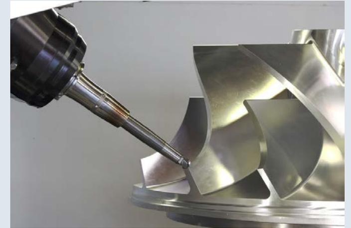
Es werden ebenfalls die drei Linearachsen (X, Y und Z) sowie zwei der Drehachsen (A, B oder C) zur Orientierung des Werkzeuges verwendet. Die Achsen werden dynamisch und simultan angestellt.
