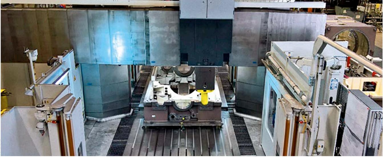
Bearbeitung von Werkstücken mit bis zu 40 t Gewicht auf der Portalfräsmaschine MasterTec 3500 AT mit der CNC Sinumerik 840D sl
