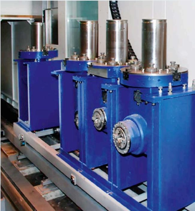
Automatische Servierstation zum Aggregatewechsel
