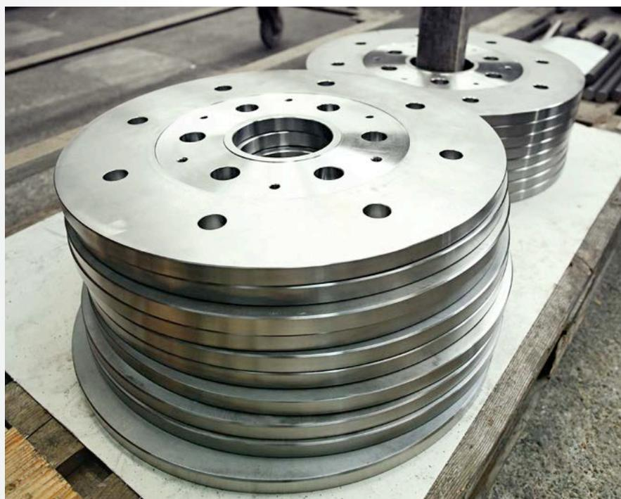
Die Rotoren der Hammermühlen drehen sich mit über 3 000 U/min – entsprechend maßgenau müssen die Komponenten gefertigt werden.
