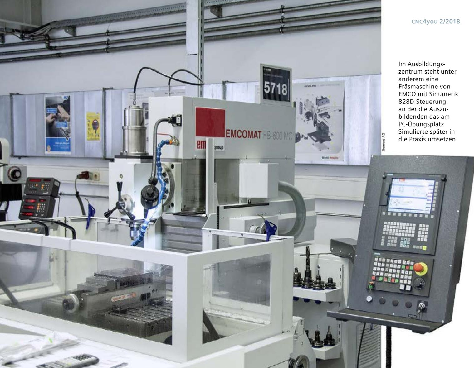
Im Ausbildungszentrum steht unter anderem eine Fräsmaschine von EMCO mit Sinumerik 828D-Steuerung, an der die Auszubildenden das am PC-Übungsplatz Simulierte später in die Praxis umsetzen
