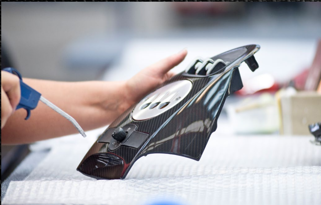
Aus den präzise zugeschnittenen Matten werden die CFK-Werkstücke aufgebaut und anschließend mit Duro- oder Thermoplasten als Matrixmaterial ausgehärtet
