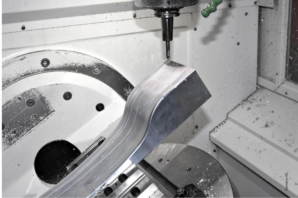
Nebenzeiten und Achsbeschleunigungen von  $5 \text{ m/s}^2$  erhöhen die Produktivität. Für eine hohe Werkstückgenauigkeit sorgt das digitale Wegmesssystem. So erreichen die Maschinen Positioniergenauigkeiten von  $T_p \text{ max.} = 10 \text{ }\mu\text{m}$  im Raum und Wiederholgenauigkeiten in den einzelnen Achsen von bis zu  $3 \text{ }\mu\text{m}$ .
