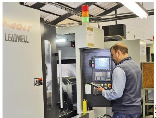
W.D. Hearn hat die Software ncTOUCH als Standardfeature in allen Leadwell CNC-Maschinen mit Sinumerik 828D installiert
