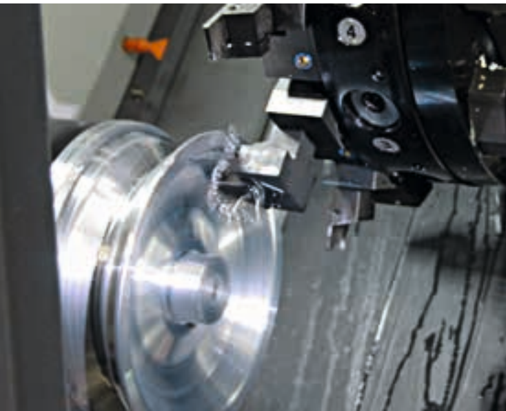
Für das Stechdrehen ist bei Wirox ein Spezialwerkzeug von Kennametal im Einsatz, das mehrere Standarddrehwerkzeuge ersetzt
