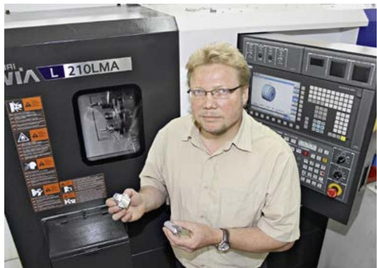
Das neue Hyundai-Drehzentrum L210LM von Grenzmann lässt sich dank automatischem Spannsystem, automatisierter Einmessung der Werkzeuge sowie der komfortabel bedienbaren CNC Sinumerik 828D schnell umrüsten
