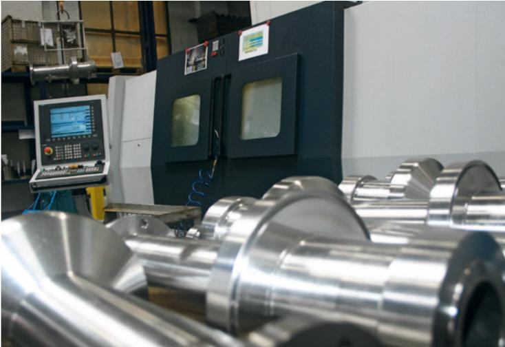
Die Sinumerik gesteuerte Spinner Drehmaschine sorgt mit anschließender Schlichtbearbeitung für Glanz und Maßhaltigkeit am Werkstück
