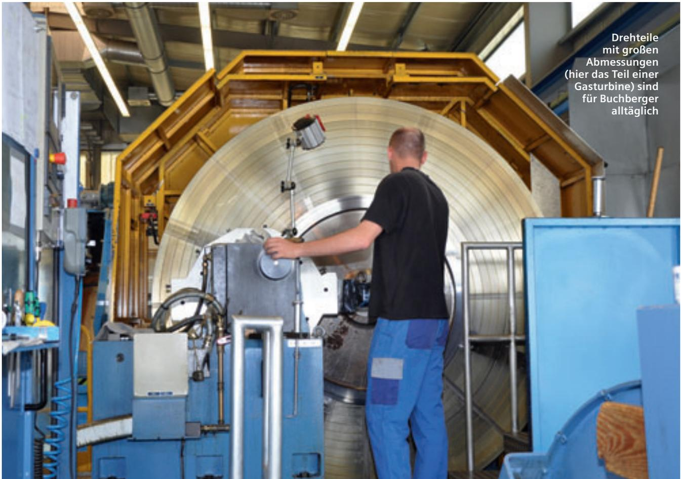
Drehteile mit großen Abmessungen (hier das Teil einer Gasturbine) sind für Buchberger alltäglich
