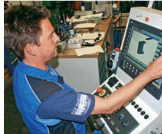
selbst komplexe 3+2-Achs-Programme lassen sich damit enorm schnell erstellen. Da der Immenstädter Betrieb primär Einzelteile und Kleinstserien herstellt, wird auf diese Weise mehr Zeit eingespart als durch den mit programGuide möglichen schnelleren Fertigungsablauf.
