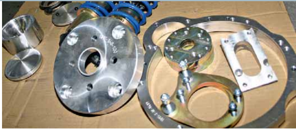
HMS fertigt für den Trabant mehr als 50 verschiedene Ersatz- und Tuningteile, beispielsweise Stoßdämpferaufhängungen oder Dichtringformen
