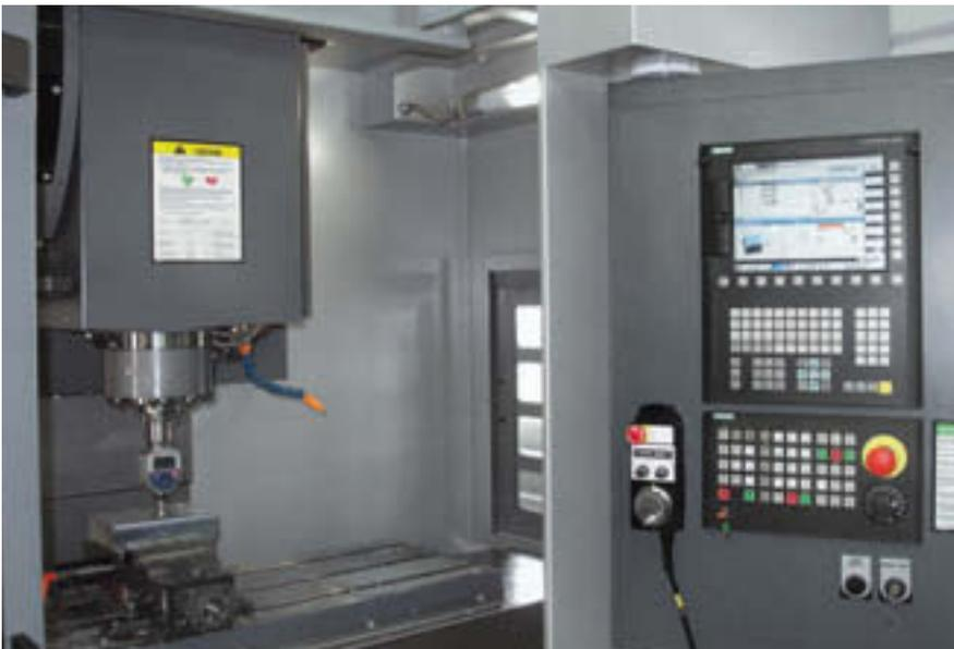
Animierte Grafiken der Bedien- und Programmier-Software ShopMill unterstützen Anwender beim schnellen Einrichten der Fräsmaschine. Messtaster ermitteln die Lage eines Werkstücks in der Maschine und übergeben die Daten an die Steuerung. Die Sinumerik 828D kann die Signale dann direkt verarbeiten
