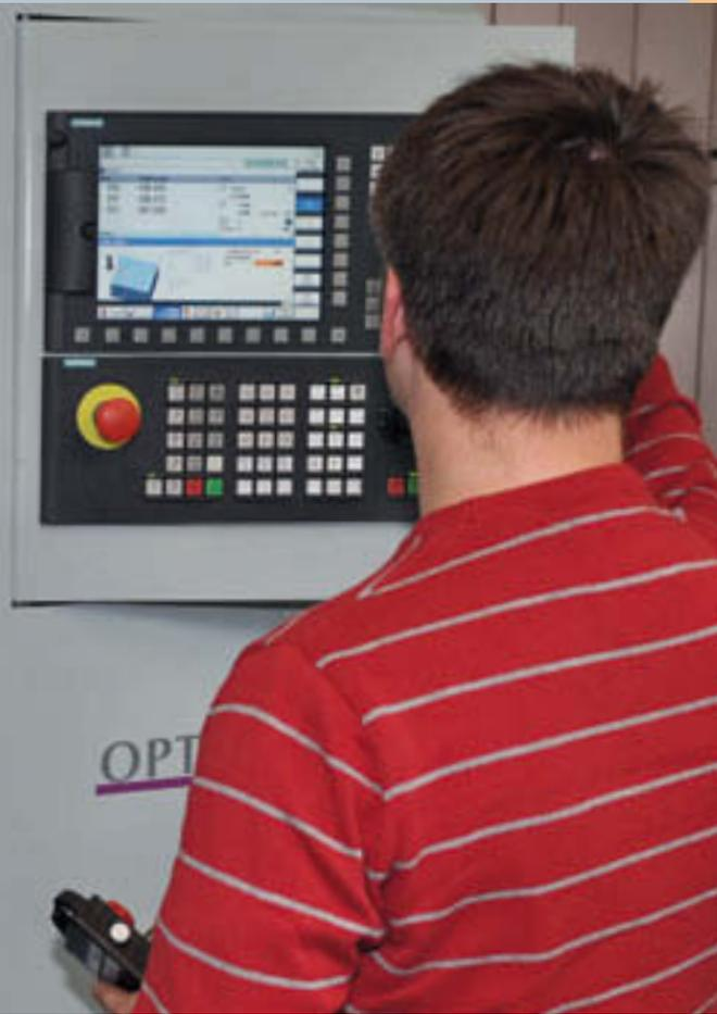
Einrichten des Nullpunkts mit mechanischem Messtaster und dem Zyklus „Kante messen“ von Sinumerik Operate
