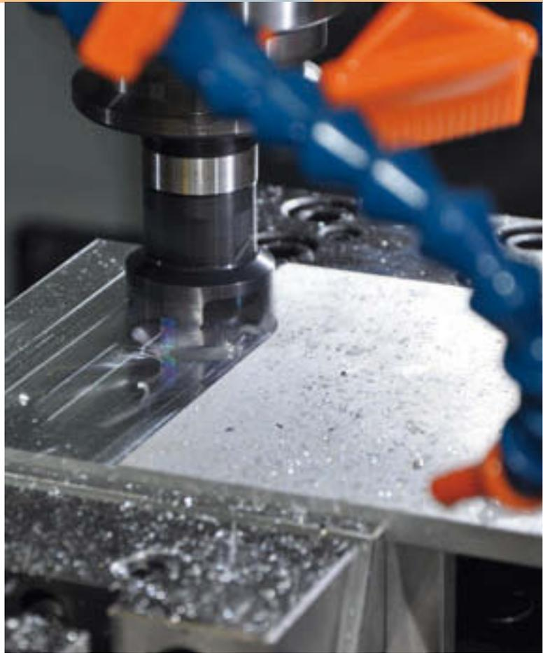
Planfräsen eines Kühlrohrteils mithilfe des Planfräszyklus
