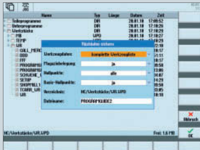
Rüstdaten sichern mit kompletter Werkzeugliste inklusive Magazinbelegung und allen Nullpunkten
