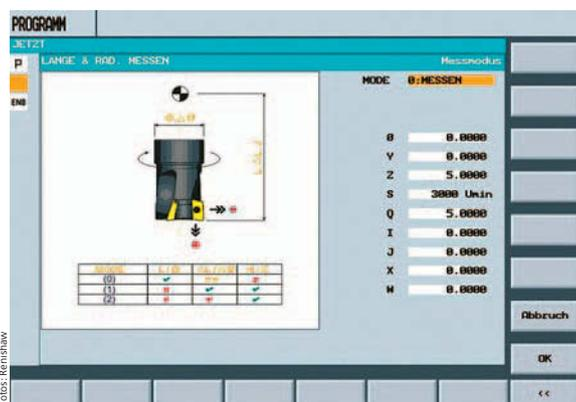
Beste Funktionalität und Bedienbarkeit: Die Werkzeugmesszyklen von Renishaw lassen sich optimal auf die Sinumerik-Steuerung übertragen
