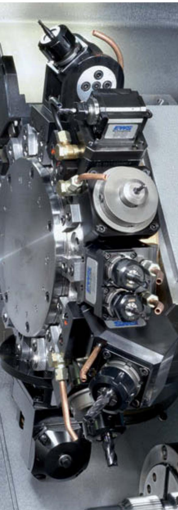
Mehrfachwerkzeughalter erlauben die Ausstattung einer Arbeitsstation mit mehreren Werkzeugen. Aus „einfachen“ Maschinen werden Bearbeitungszellen, die Werkstücke komplett bearbeiten
