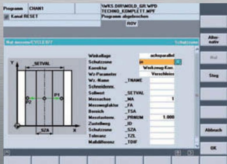
Automatikmesszyklus Prozessmessen: Nut messen mit Werkzeug-Korrektur
