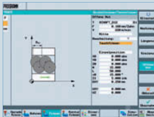
Zyklus „Offene Nut“ bei der Frässtrategie Tauchfräsen
