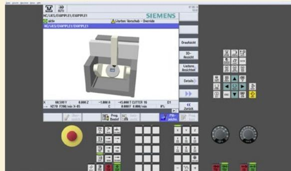
Mit Sinutrain steht Anwendern ein perfektes Werkzeug für das einfache Lernen und professionelle Training von CNC-Funktionen zur Verfügung. Bei der CNC-Bedienung und -Programmierung bietet das Programm ein identisches Verhalten wie eine reale Sinumerik. Mit der neuen Softwareversion 4.5 ED.2 ist nun die Funktion Collision
