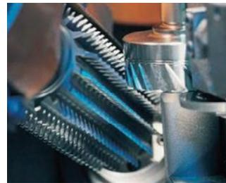
**S**inumerik 828D und 828D Basic sind nun auch für das Zahnradfräsen an einfachen Verzahnungsmaschinen geeignet, denn die Steuerung beherrscht die elektronische Königswelle. Das ermöglicht die gekoppelte Bewegung von Achsen ohne mechani-
