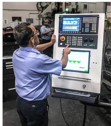
Die neue CNC Sinumerik 828D bietet GKN moderne Steuerungstechnologie
