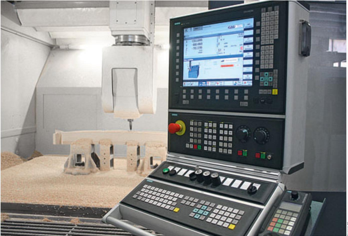
Sinumerik 840D sl mit Sinumerik Operate und Sinumerik MDynamics ist neben der Maschinenkonstruktion entscheidend für die hohe Produktivität und Qualität bei der Fertigung von Kunststoffmodellen
