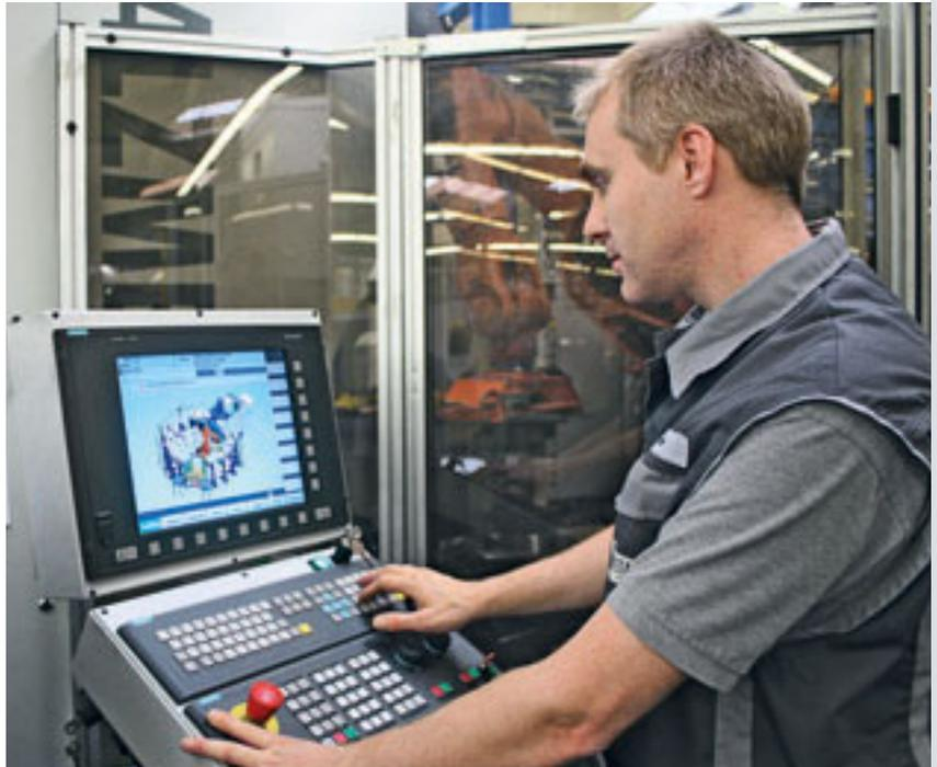
Die Benutzeroberfläche von Sinumerik Operate gleicht in vielen Details der eines PCs. Beim Einrichten wird der Bediener durch grafische Darstellungen und animierte Bilder unterstützt
