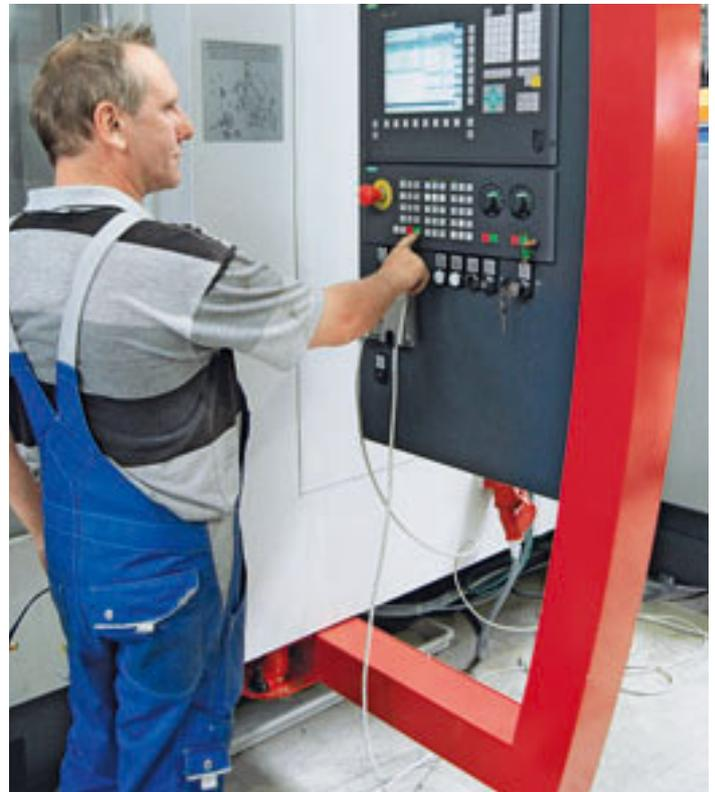
Die Sinumerik 840D sl am sogenannten C-Bügel ist ein signifikantes Merkmal aller Samag-Bearbeitungszentren
