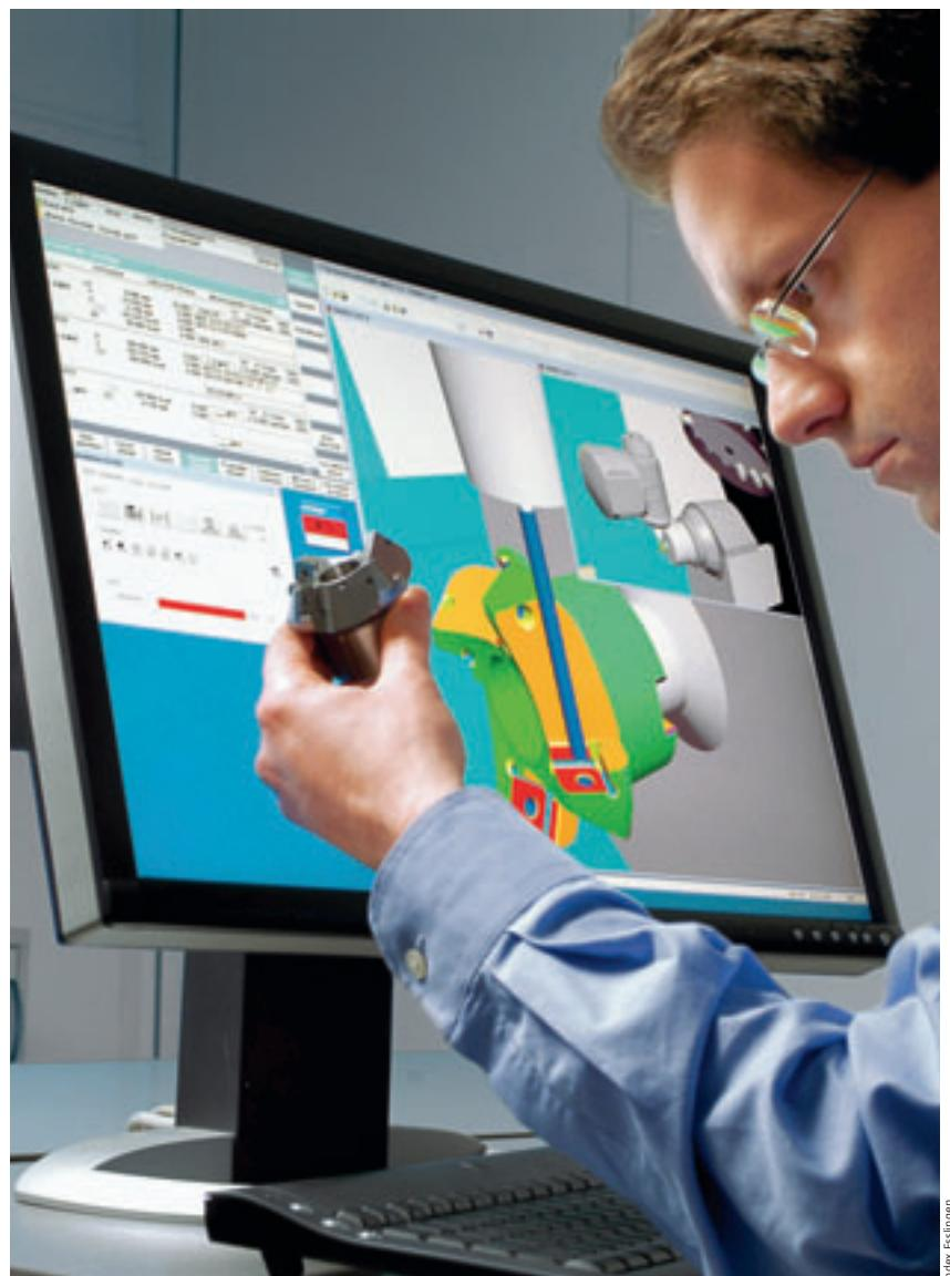
仮想マシンによって、コントローラ駆動型のシミュレーション環境で確実にNCプログラムを検証、最適化可能
