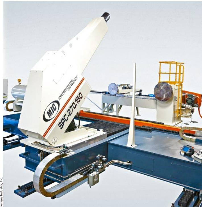
Die Maschine von MJC Engineering formt Aluminiumbleche zu Einlauflippen für die Triebwerksgondeln
