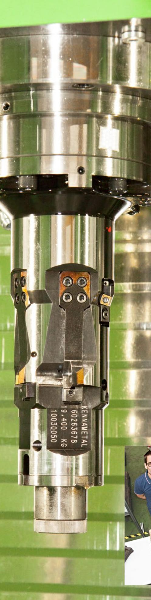
Auch die Produktionskapazität ist dank der hohen Drehzahl und Vorschubgeschwindigkeit überragend. Im Lastenheft des Kunden wurde eine Kapazität von 24 Pleuelstangen in acht Stunden gefordert. Mit 48 Teilen hat Ceri dieses Ziel weit übertroffen – eine beachtliche Leistung angesichts der Bearbeitung des harten Schmiedestahls und der großen Abmessungen der Werkstücke.
