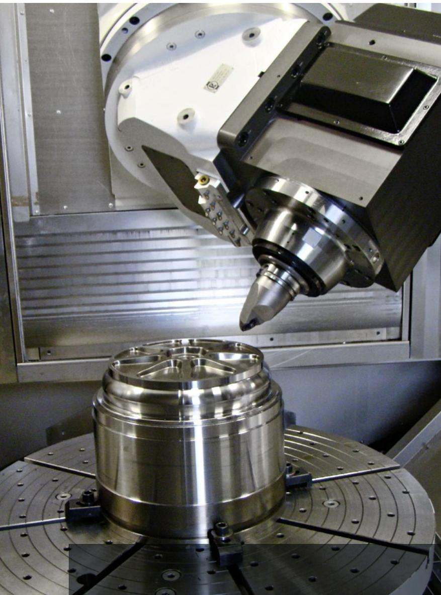
Um komplexe Fräs- und Drehteile an einer Maschine zu bearbeiten, hat Huron Graffenstaden auf Grundlage eines 5-Achs-Vertikalzentrums eine Multitasking-Maschine entwickelt. Die Drehfunktionen an der Frässchnittstelle stellt die in einer Vorpremiere eingesetzte neue Software MillTurn bereit.
