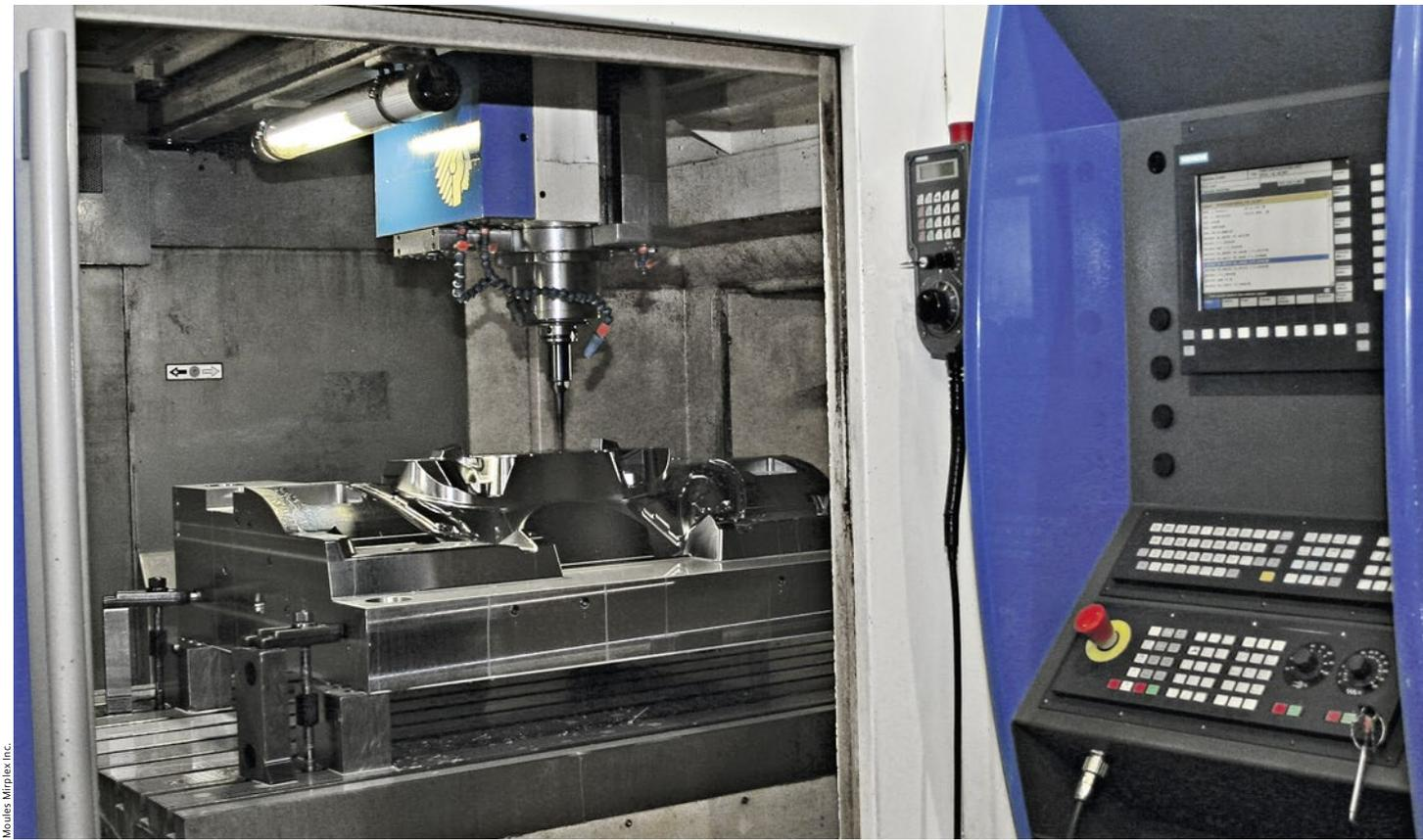
Steuerung Sinumerik 840D und Werkzeugmaschine Huron KX30
