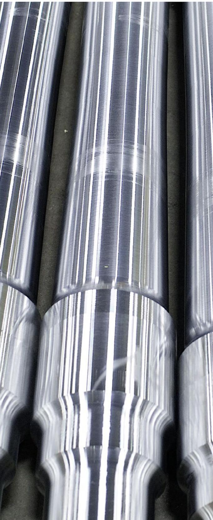
Aus Freiformschmiedestücken, die in der komplett erneuerten Snyder-Anlage bearbeitet werden, entstehen präzise geschliffene Eisenbahnnachsen
