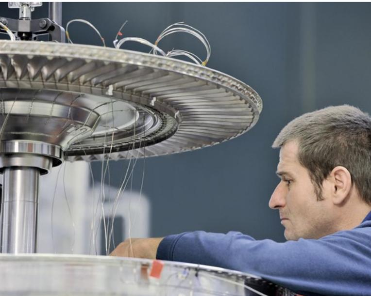
Mit ein und demselben Teileprogramm entstehen auf jeder der zehn bis heute installierten Maschinen nahezu identische Blisks höchster Qualität
