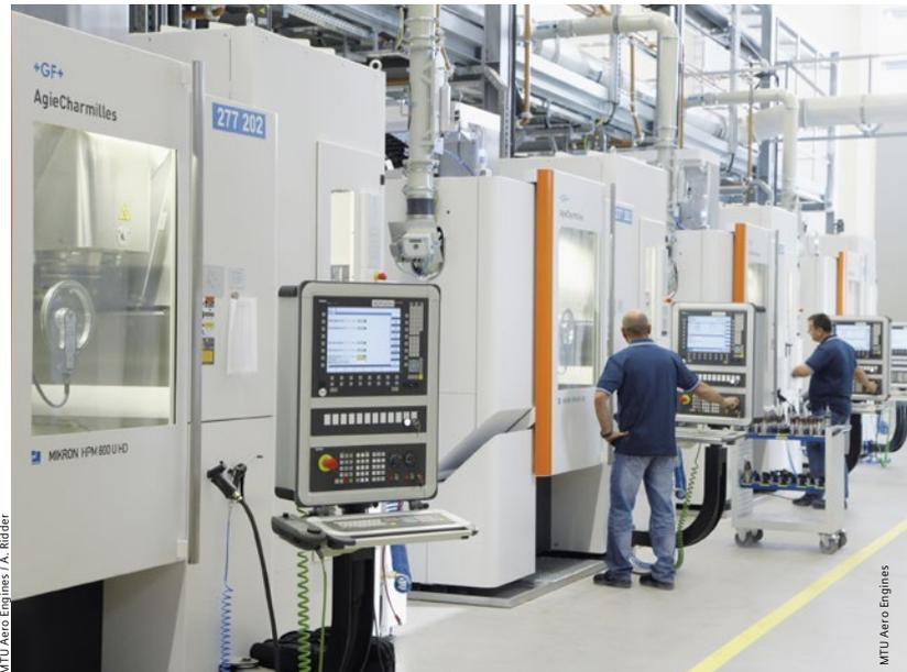
MTU Aero Engines setzt für seine neue Blisk-Fertigung in München Schlüsselgleiche High-Performance-5-Achs-Fräszentren ein
