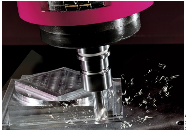
スピンドルは、高速、高トルクで、アルミニウム、カーボンファイバー、鋼、チタンなどの素材をカットできるように設計されている
