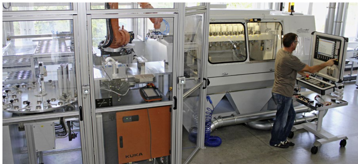
Run MyRobot ソフトウェア・インターフェースのおかげで、Silhouette の生産労働者は、ロボットの使用に不安がありません。まるで他の多軸工作機械と同じように、Sinumerik 840D sl オペレーター・パネルを使用して、制御することができるからです
