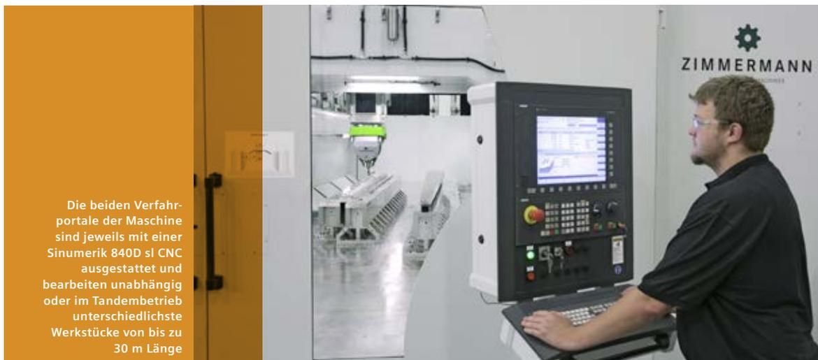
Die beiden Verfahrgportale der Maschine sind jeweils mit einer Sinumerik 840D sl CNC ausgestattet und bearbeiten unabhängig oder im Tandembetrieb unterschiedlichste Werkstücke von bis zu 30 m Länge
