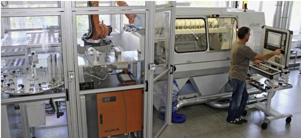
Dank der Softwareschnittstelle RunMyRobot haben die Fertigungsmitarbeiter von Silhouette keine Berührungsängste gegenüber dem Roboter. Sie können ihn wie jede andere Achse der Werkzeugmaschine mit dem Bedienerpanel der Sinumerik 840D sl steuern
