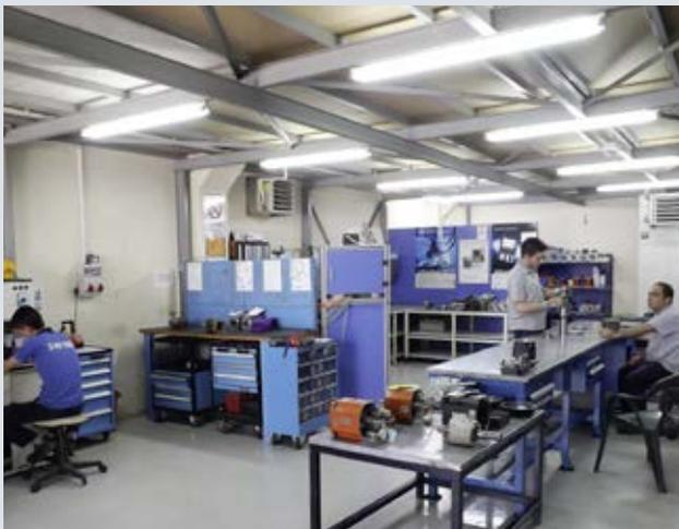
Alle SWSS-Stützpunkte verfügen über die erforderlichen Maschinen und Montageplätze sowie Spezialwerkzeuge für die Spindelreparatur
