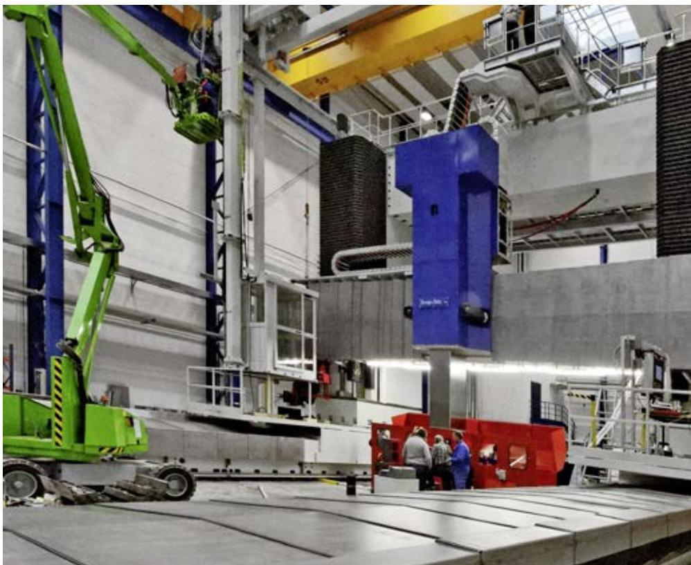
Diese Maschine in Gantry-Bauweise mit 21 m Verfahrweg in x- und 9 m in y-Richtung sowie einer Portaldurchgangsbreite von 8,5 m ist wie die ganze Maschinenreihe eine vollständige Neuentwicklung. Die sich daraus ergebenden Projektrisiken minimierte Dörries Scharmann mit Droop+Rein unter anderem durch den konsequenten Einsatz durchgängiger Steuerungs- und Antriebstechnik von Siemens. So konnten
