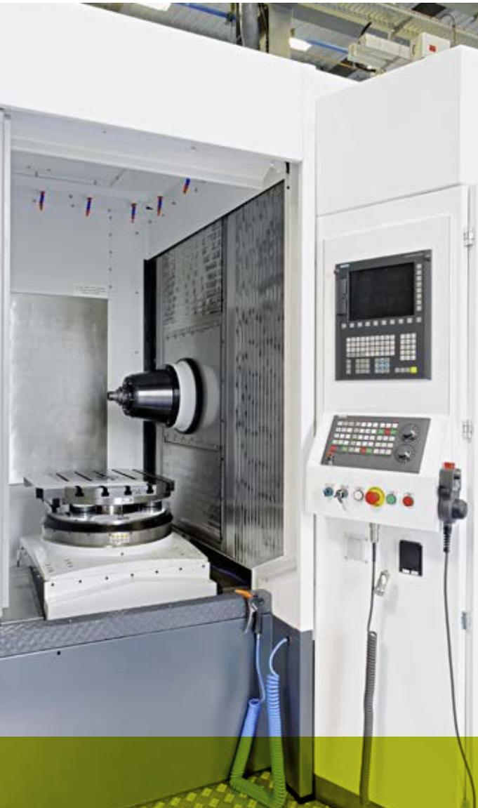
Anwender profitieren von der einfachen ShopMill Programmierung in Sinumerik Operate – gerade auch bei kleineren Maschinen, die mit Sinumerik 828D ausgestattet sind
