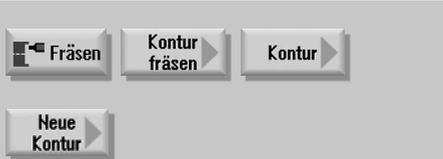
Sie können offene Konturen oder geschlossene Konturen (Taschen, Inseln, Zapfen) definieren und mit Bahnfräsen oder Fräszyklen bearbeiten.
