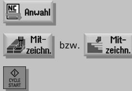
Bei Bedarf können Sie das Mitzeichnen während der Abarbeitung des Werkstücks aktivieren.
