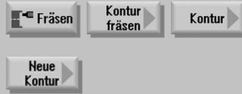
Erstellen Sie die Rohteil- und Fertigteilkontur im Konturrechner.
