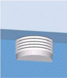
Zyklus zum Herstellen von Innen- oder Außengewinden durch die Technologie Fräsen auf beliebigen Positionen/ Positionsmustern
