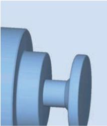
Stechdrehzyklus zum Bearbeiten beliebiger Konturen mit der Technologie Stechdrehen, kombinierbar mit automatischer Restmaterialeerkennung
