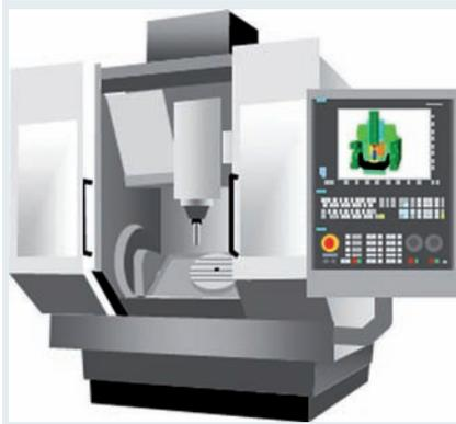
Die Option SINUMERIK Collision Avoidance bietet optimalen Schutz vor ungewollten Kollisionen von beweglichen Maschinenkomponenten mit statischen Maschinenkomponenten. Die Kollisionsüberwachung ist auch bei komplexen Bearbeitungen wie z. B. 5-Achs-Simultanfräsen oder Drehen mit B-Achse möglich.
