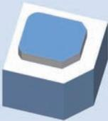
Zyklus zum Herstellen beliebiger Zapfenkonturen mit definierbarem Ausgangsrohteil, kombinierbar mit automatischer Restmaterialerkennung
